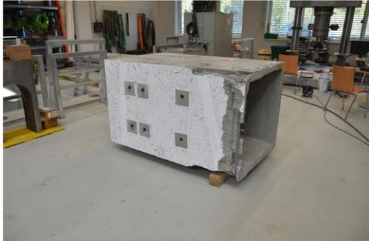
Abb. 25: Zerstörter Versuchskörper nach dem Überschreiten der zulässigen Druckspannungen in den dünnwandigen Platten
