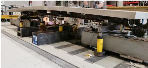
Abb. 10: Versuchsaufbau Belastungsversuche an dünnwandigen Platten nach erfolgtem Versuch
