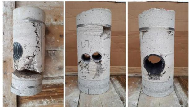
Abb. 34: Spritzschatten bei Halbfertigteilen die mit Spritzbeton ergänzt wurden: verschiedene Typen und Durchmesser von Hüllrohren (entnommen aus [16])
