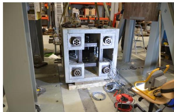
Abb. 24: Fertiger Versuchskörper mit nachträglich aufbetonierten Lisenen
