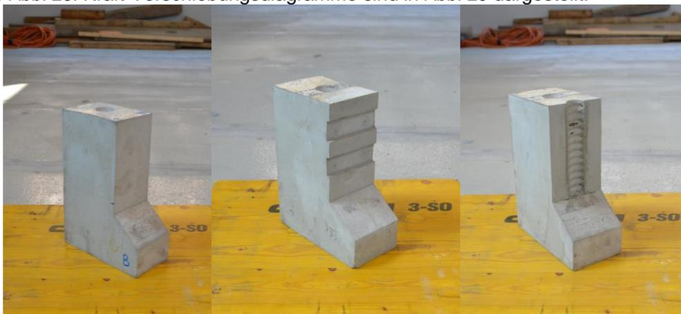
Abb. 27: Glatte Oberfläche, Schubnocken, Fuge mit profilierter Nut
