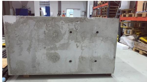
Abb. 26: Zerstörter Versuchskörper mit Versagen im Lasteinleitungsbereich
