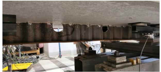
Abb. 11: Versuchskörper mit kreisrunden Löchern, ohne Verstärkung nach dem Belastungstest
