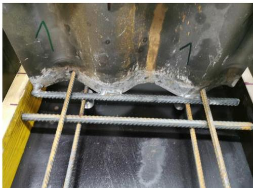
Abb. 8: Verbundvariante angeschweißte Längsstäbe mit zusätzlicher oberer Biegebewehrung (L5 und L6 im Last-Verformungsdiagramm)
