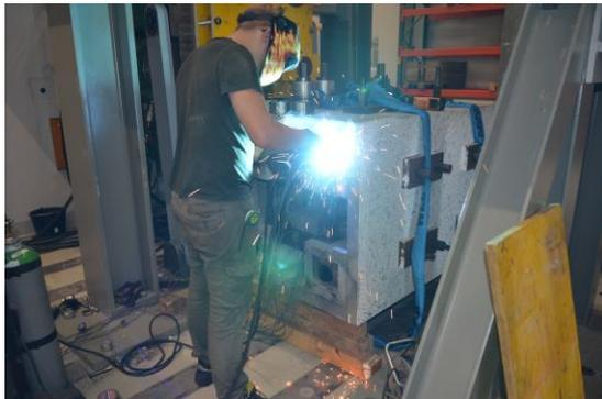
Abb. 21: Anschweißen der Ankerkörper
