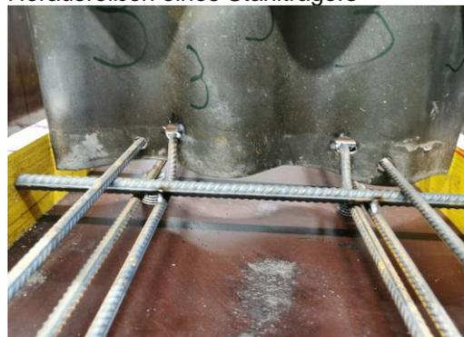
Abb. 9: Verbundvariante durchgesteckte gebogene Querstäbe mit zusätzlicher oberer Biegebewehrung (L7 und L8 im Last-Verformungsdiagramm)
