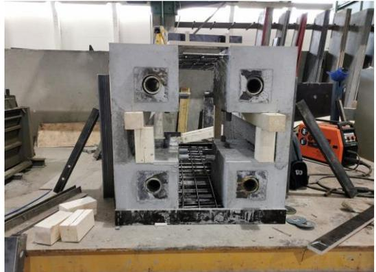
Abb. 20: Lisenen nach dem Betonieren der Stege
