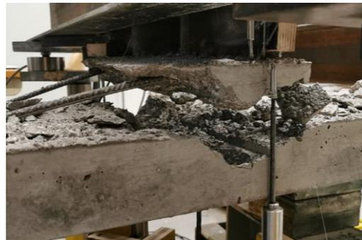
Abb. 7: Ausziehversuch nach Herausreißen eines Stahlträgers
