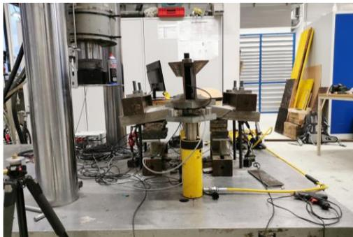
Abb. 6: Versuchsaufbau Ausziehversuche
