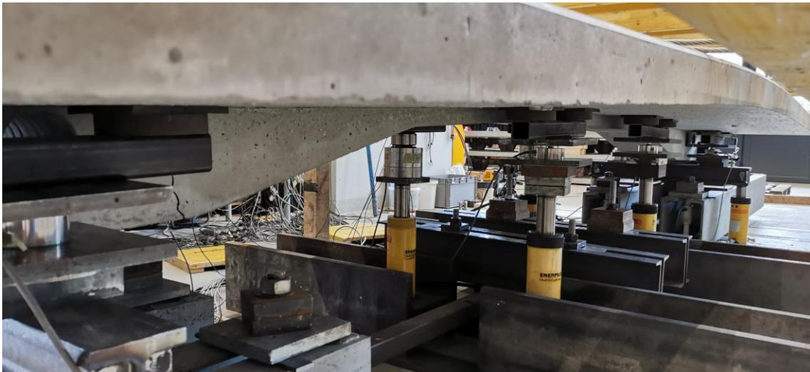
Abb. 5: Experimentelle Untersuchung des Alternativvorschlags für das dünnwandige Betonsegment
